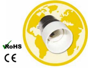
**EQ0364** Douille d'adaptation d'un culot baïonnette B22 vers un petit culot à vis E14. Convient pour les ampoules fluocompactes, halogènes et LED. Tension d'utilisation de 12 V à 240 V. Puissance maximale de l'ampoule à utiliser : 60 W. Résistance à la température jusqu'à 250°C.
