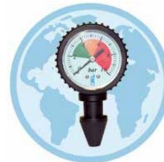
**EQ0606** Vérifiez rapidement la pression d'eau des robinets. Mesure entre 0 et 10 Bars et température maximum 60°C. Sans joint, sans clé, sans vissage, juste par emboîtement du cône de mesure. Permet le contrôle rapide de la pression sur n'importe quel orifice dont le diamètre est compris entre 8 et 20 mm, IP 65, classe 2.5, Ø 50 mm. Marquage couleur des plages de pression.
