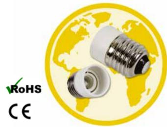
**EQ0366** Douille d'adaptation d'un gros culot à vis E27 vers un petit culot à vis E14. Convient pour les ampoules fluocompactes, halogènes et LEDs. Tension d'utilisation de 12 V à 240 V. Puissance maximale de l'ampoule à utiliser : 60 W. Résistance à la température jusqu'à 250°C.
