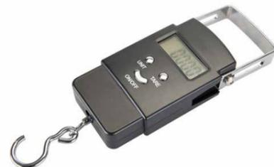
**EQ0518** Ce peson permet d'avoir une action de sensibilisation sur le gaspillage alimentaire. Permet des pesées et mesures rapides de 0,20 kg à 50 kg avec une précision de 0,5 kg. Mesure métrique et impériale. Affichage numérique LCD. Si le poids dépasse la capacité de pesée de l'appareil «O-LD» s'affichera. En dessous de 0,20 kg, le peson affichera le signe «<->» sur la gauche de l'écran.
