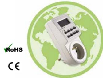
**EQ0706** Programmeur digital permettant d'économiser l'énergie électrique, de simuler une présence à domicile en cas d'absence et d'automatiser le fonctionnement des appareils. Permet le déclenchement et l'extinction programmé des appareils électriques sur une période de 7 jours. 10 programmes de fonctionnement. Puissance max : 3 600 W / IP 20 / prise sécurité enfant.
