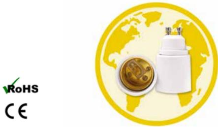
**EQ0707** Douille d'adaptation spot GU10 vers gros culot à vis E27. Convient pour les ampoules fluocompactes, halogènes et LED. Tension d'utilisation de 12 V à 240 V. Puissance maximale de l'ampoule à utiliser : 60 W. Résistance à la température jusqu'à 250°C.
