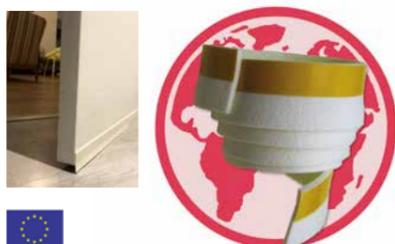
**EQ0542** Cet équipement se colle sur le bas de la porte pour isoler et éviter la déperdition de chaleur entre les pièces chaudes et les pièces froides. Longueur 1 M à découper selon la taille de la porte. Adhésif puissant pour un collage longue durée. Isolation thermique et phonique. Espace d'isolation de 2 cm. Pour sol lisse et régulier.
