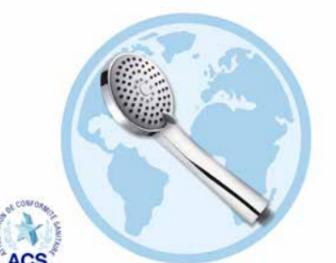
**EQ0272** Pommeau de douche design ayant un débit de 8,5 L/min avec une pression de 2 à 5 bars. 3 jets pour plus de confort : 1 jet dynamique, 1 jet pluie faible et 1 jet mixte. Picots anti-calcaire pour une maintenance réduite. Plastique ABS très résistant.
