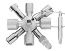
**EQ0770** La clé 10 empreintes est idéale pour les coffrets eau, gaz et électricité. Elle est à utiliser pour les ouvertures et fermetures des coffrets, chauffage, sanitaire, climatisation, ventilation, gaz et eau. Possède un système d'arrêt. Embouts : Clé carré femelle : 5 ; 6-7 mm ; 8-9 mm ; 10-11 mm. Clé triangulaire : 7-8 mm ; 9-10 mm ; 11-12 mm. Panneton double : 3-5 mm. Fente demi-lune : 6 mm. 4 pans : 6-9 mm.
