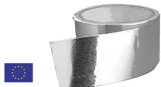
**EQ0843** Ruban adhésif en aluminium pour faciliter l'installation des réflecteurs pour radiateur et toutes les solutions d'isolation. Épaisseur 30 microns. Résistant aux fortes températures (-30 à +120°C), aux UV et à l'humidité pour un usage intérieur et extérieur. Qualité professionnelle / Excellente résistance à l'usure. Rouleau de 50 Mètres de long avec une bande adhésive de 5 cm adapté au jointage.
