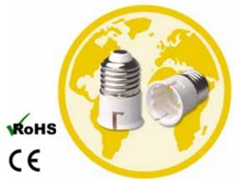
**EQ0367** Douille d'adaptation gros culot à vis E27 vers un culot à baïonnette B22. Convient pour les ampoules fluocompactes, halogènes et LED. Tension d'utilisation de 12 V à 240 V. Puissance maximale de l'ampoule à utiliser : 60 W. Résistance à la température jusqu'à 250°C.
