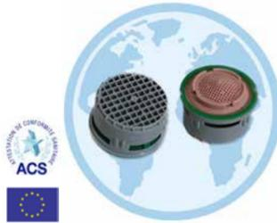
**EQ0321** Aérateur pour robinet qui se place dans une bague mâle ou femelle. Cet aérateur auto-régulé a un débit de 3 litres par minute quelque soit la pression (débit constant). Installation sur tous les robinets de cuisine et de salle de bain.
