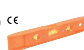
**EQ0802** Ce niveau de poche est en plastique ABS résistant. Ce niveau a une base magnétique et est composé de 3 fioles de 45°, 90° et 180°. Possède un trou de suspension pour un rangement facile. Les extrémités du niveau sont lisses pour plus de confort lorsque vous le glissez dans la poche. Extrémités coniques. Idéal pour les travaux de rénovation.
