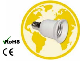
**EQ0365** Douille d'adaptation d'un petit culot à vis E14 vers un gros culot à vis E27. Convient pour les ampoules fluocompactes, halogènes et LED. Tension d'utilisation de 12 V à 240 V. Puissance maximale de l'ampoule à utiliser : 60 W. Résistance à la température jusqu'à 250°C.
